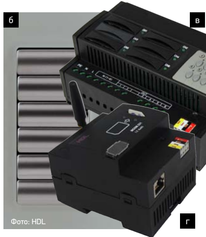
↑↓ Компоненты системы умного дома HDL на DIN-рейку: универсальный шестиканальный диммер, максимальная нагрузка 1А на канал HDL-BUS (а); шестикопытный настенный переключатель (б); универсальный 6-канальный диммер со встроенным контроллером сценариев, нагрузка 2 А на канал (в); модуль для отправки SMS-сообщений (г)
